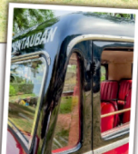
Cette très belle carrosserie comprend deux petites glaces triangulaires placées entre le montant de pare-brise et la portière articulée à la verticale.
