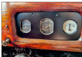
Le petit compteur de vitesse est évidemment très optimisé. A sa droite, un mano de température d'eau a été ajouté en attendant d'en trouver un qui s'intègre mieux à l'ensemble.
