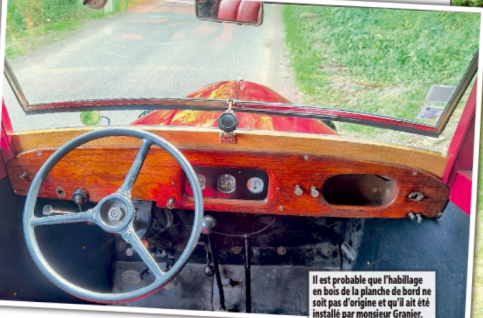
Sur la colonne de direction se trouvent les tirettes de réglage d'avance, de démarreur et de starter. Sur la platine en bois, il s'agit du bouton de contact.
