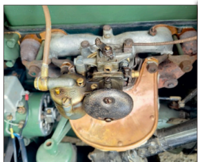
À l'image de Tracção avant les "Perfo", le moteur est équipé d'un carburateur horizontal.
