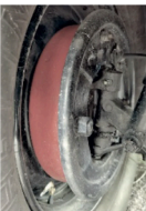
Grâce aux tambours de 305 mm, le freinage est loin d'être ridicule.
